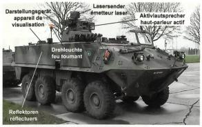
Die Simulatorausrüstung mit Lasersender, Reflektoren, Empfänger, Darstellungsgerät, Drehleuchte und Aktivlautsprecher.
