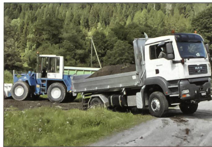
Beim abgebildeten Lastwagen handelt es sich um den MAN TGA 18.430 4x4 mit Dreiseiten-Kipper, wie er von Schweizer Kunden eingesetzt wird.
