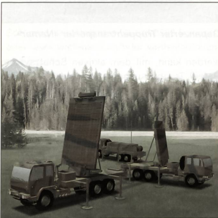
Die Darstellung zeigt das neu zu entwickelnde Feuerleitradar des mobilen Luftverteidigungssystems MEADS, das gemeinsam von Deutschland, Italien und den USA unterstützt wird. Mit der Lieferung der ersten Prototypen wird zwischen 2012 und 2014 gerechnet.
