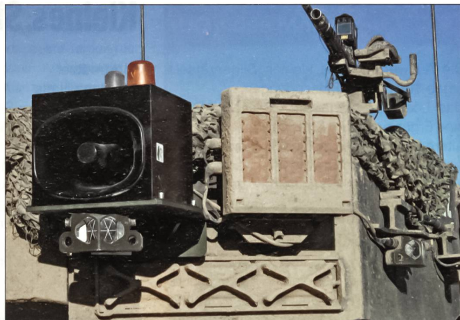
Der neue Laserschusssimulator, installiert am Kampfpanzer 87 Leopard WE.
