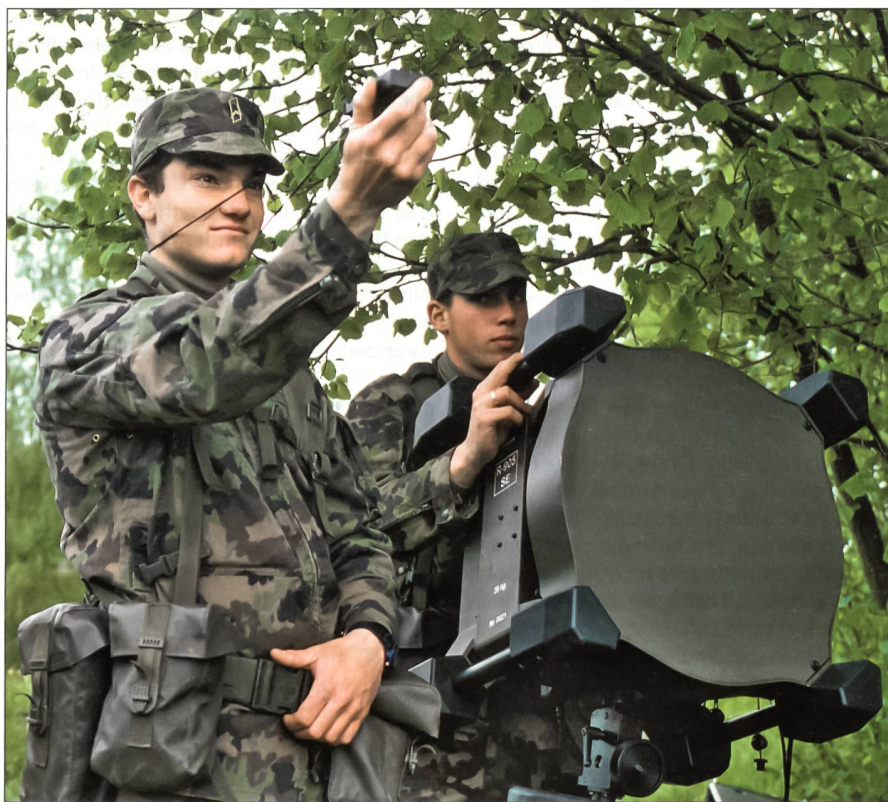
Zwei Spezialisten der Übermittlungstruppen beim Einrichten des Richtstrahlsystems R-905 im Gelände.
