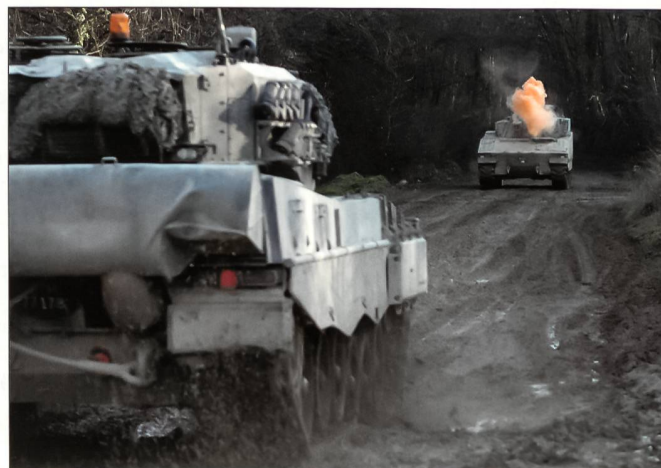
Ein Begegnungsgefecht mit dem Laserschusssimulator zwischen einem Kampfpanzer 87 Leopard WE und einem Schützenpanzer 2000. Der rote Rauch zeigt den Treffer an.
