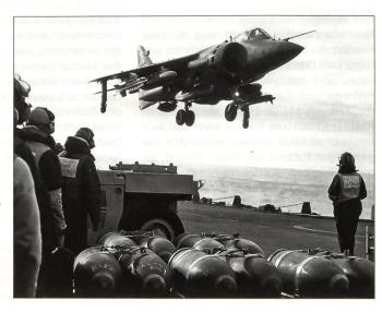
Eine Sea Harrier der No 801 Squadron, bewaffnet mit Sidewinder Luft-Luft-Lenkwaffen, Zusatztanks und Bomben, hebt vom Deck der HMS Invincible ab.
