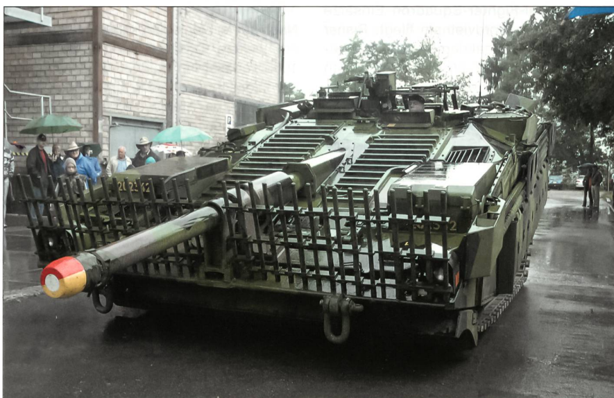
Schwedischer Kampfpanzer Stridsvagn 103c: Die Höhengausrichtung der Kanone wird mit hydraulischem Heben oder Senken des Fahrwerks herbeigeführt.
