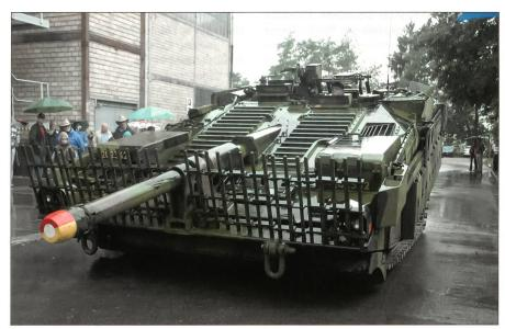
Schwedischer Kampfpanzer Stridsvagn 103c: Die Höhenausrichtung der Kanone wird mit hydraulischem Heben oder Senken des Fahrwerks herbeigeführt.
