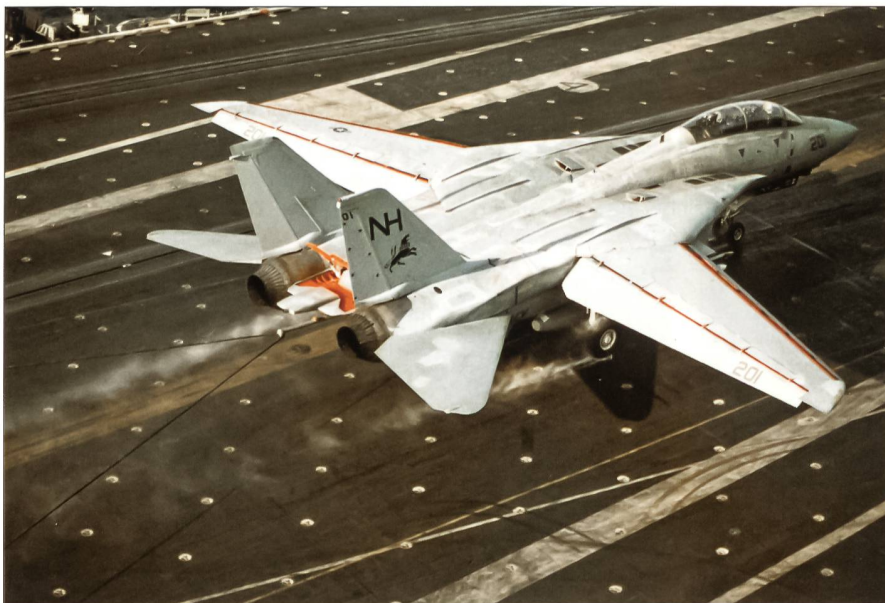
Eine F-14 Tomcat der Fighter-Squadron 114 ist eben auf dem Flugzeugträger USS Enterprise (CVN 65) vor der Küste von Adak in den Aleuten gelandet. Deutlich ist das vom Fanghaken gepackte Bremsseil erkennbar. Während die Marineflugzeuge in früheren Jahren teils noch buntfarbige Anstriche aufwiesen, verfügten sie aus taktischen Gründen später nur noch über den grauen Anstrich.
