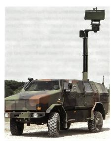
Bodenüberwachungsradar auf Dingo-2.
