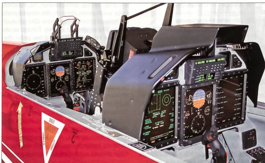
Der PC-21 ist ein Doppelsitzer. Das Kernstück bildet das neue digitale Cockpit. Die multifunktionalen Bildschirme sind jenen eines modernen Kampfflugzeuges nachgebildet.
