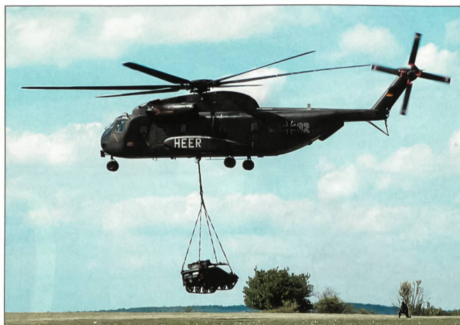
Zwei Wiesel passen in einen mittleren Transporthubschrauber (MTH) CH-53G, und er kann auch als Aussenlast transportiert werden. Die Besatzung besteht aus zwei Soldaten.
