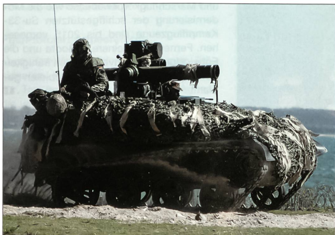
Der Waffenträger Wiesel ist ein kleiner und flinker Luftlandepanzer, der mit einer 20-mm-MK oder mit dem Panzerabwehrsystem TOW bestückt werden kann.
