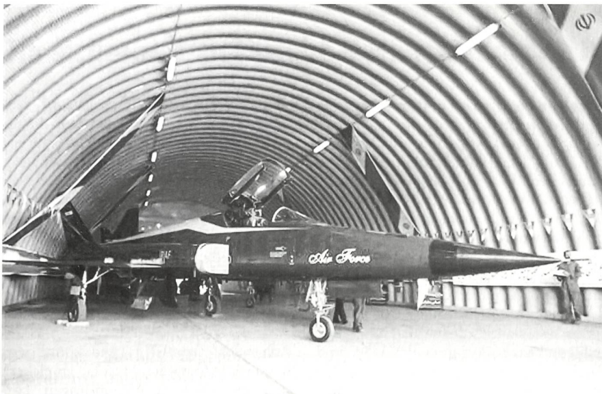
Anlässlich der Truppenparade zum Nationalfeiertag 2007 wurde der Öffentlichkeit erstmals das neue Kampfflugzeug des Typs «Saegheh», eine Eigenentwicklung, gezeigt. Diese ähnelt vorne stark dem F-5, das Seitenleitwerk dem F/A-18.
