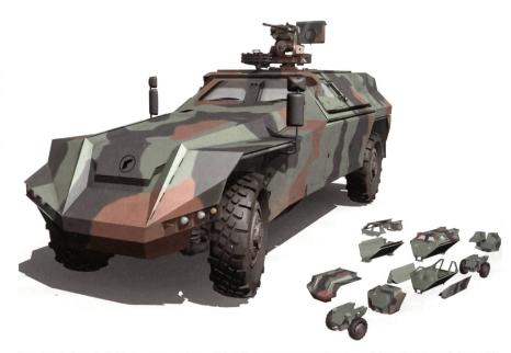
So sieht das 4x4-Fahrzeugsystem GEFAS zusammengebaut und in Einzelmodulen aus-Die Motorleistung beträgt 410 kW, die Höchstgeschwindigkeit rund 80 km/h, die Einsatzweite rund 700 km, das Einsatzgewicht des 4x4 beträgt 17,5 t, die Länge 7,8 m, die Breite 2,55 m und die Höhe 2,4 m. Klein die einzelnen Module.
