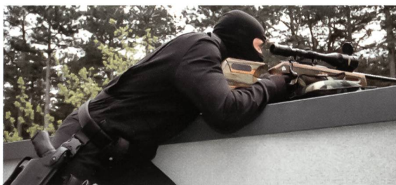
EKO-COBRA-Scharfschütze in Stellung. Das CISM-Gewehr besitzt ein SBS-96-Verschlussystem, einen justierbaren Schichtholzschaft, einen Druckpunktabzug sowie einen gehämmerten Matchlauf. Auf der Waffe sitzt ein Swarovski-Zielfernrohr 6-24x50.
