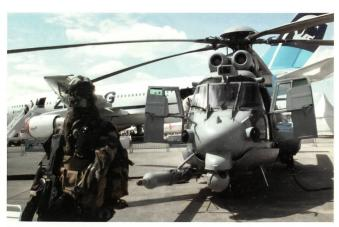
Flugzeuge und Helikopter werden zunehmend für Aufgaben von Spezialkräften eingesetzt (Special Forces). Diese Aufnahme zeigt eine Version des Super Pumas für die französischen Spezialkräfte, seitlich mit Luftbetankungsvorrichtung.
