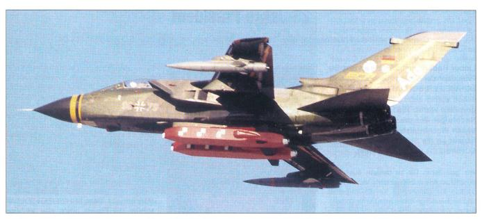
Der Luft-Boden-Marschflugkörper Taurus KEPD 350 (hier angehängt an einem Tornado-Kampfflugzeug) wird weiter ausgebaut. Er soll in Zukunft in der Lage sein, Ziele auf eine Distanz bis 500 km zu bekämpfen. Dank Data Link wird es möglich werden, den Auftrag während des bodennahen Fluges der Lenkwaffe zu überwachen, zu ändern oder den Einsatz abzubrechen.
