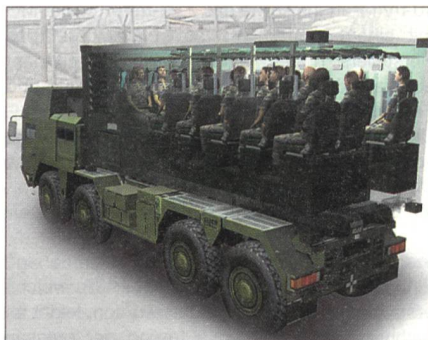
Der Container bietet Platz für 18 Personen. Mit Hilfe eines Hakenladesystems ist ein schnelles Auf- und Abladen auf das Transportfahrzeug möglich.
