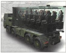
Der Container bietet Platz für 18 Personen. Mit Hilfe eines Hakenladesystems ist ein schnelles Auf- und Abladen auf das Transportfahrzeug möglich.
