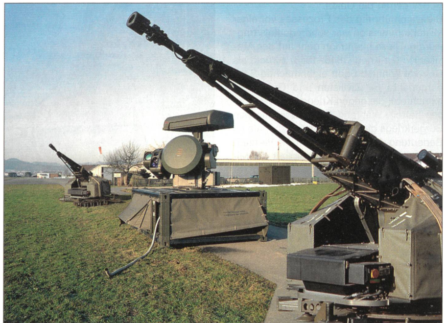
Das System Skyshield mit zwei Kanonen und dem Feuerleitgerät.
