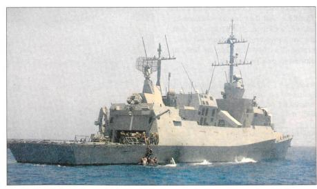
Das Bild zeigt die Hanit, die dritte israelische Korvette der Saar-5-Klasse. Das Schiff wurde von Northrop Grumman gebaut und 1995 von den Israeli in Dienst gestellt. Der «geknickte» Rumpf deutet auf das radarabweisende Profil des Schiffes hin (Stealth-Eigenschaften). Die Korvette wurde am 14. Juli 2006 im Heckbereich von der C-802 der Hisbollah getroffen.
