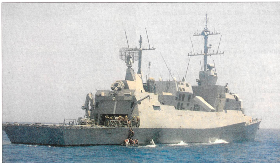
Das Bild zeigt die Hanit , die dritte israelische Korvette der Saar-5-Klasse. Das Schiff wurde von Northrop Grumman gebaut und 1995 von den Israeli in Dienst gestellt. Der «geknickte» Rumpf deutet auf das radarabweisende Profil des Schiffes hin (Stealth-Eigenschaften). Die Korvette wurde am 14. Juli 2006 im Heckbereich von der C-802 der Hisbollah getroffen.
