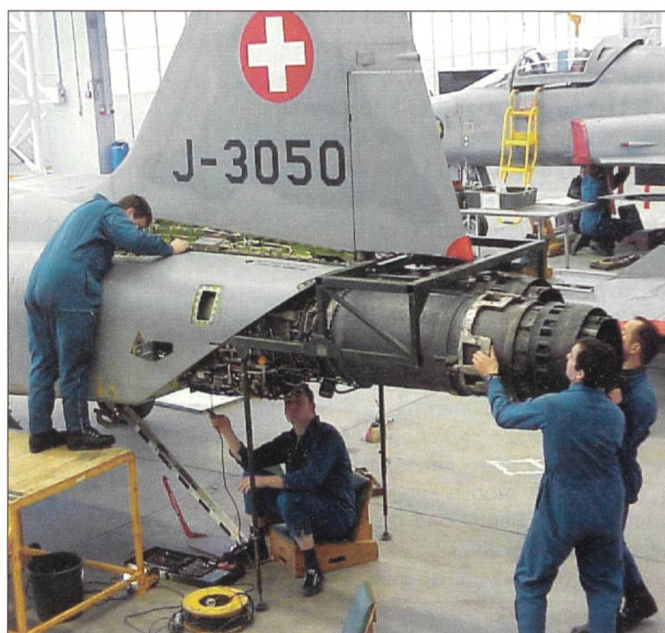
Fliegersoldaten beim Einbau eines Triebwerks am F-5 Tiger.
