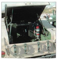
HMMWV mit Feuerunterdrückungssystem und vergrösserter Heck(Not)Ausstiegsluke.
