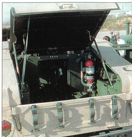
HMMWV mit Feuerunterdrückungssystem und vergrößerter Heck(Not)Ausstiegs Luke.
