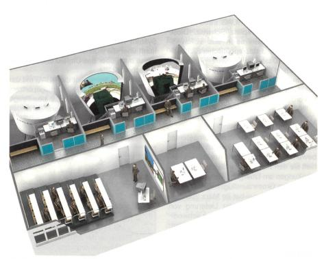
Die Fahrschulanlage für den Kampfpanzer Leopard und den Schützenpanzer 2000 enthält einen Arbeitsplatz für den Instruktor und die Kapsel mit dem Cockpit für den Fahrschüler.
