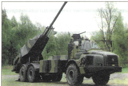
FH-77 BW L52 auf Volvo-6x6-Geländefahrzeug.
