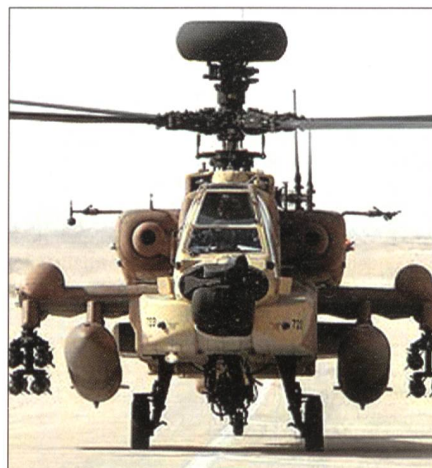
Israelischer «Apache» AH-64D, genannt «Saraf», mit mastmontiertem Feuerleitradar.
