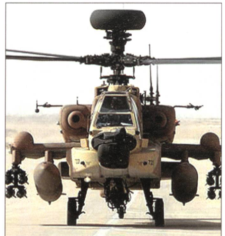
Israelischer «Apache» AH-64D, genannt «Saraf», mit mastmontiertem Feuerleitradar.
