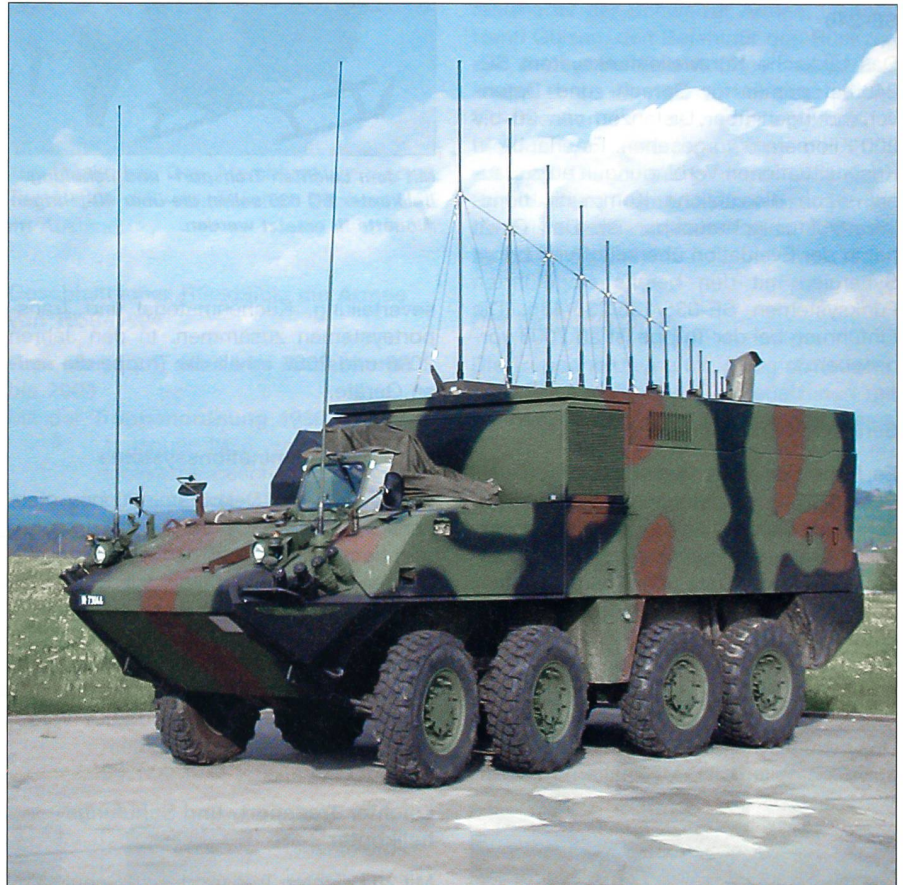
Das Integrierte Funkaufklärungs- und Sendesystem (IFASS) leistet einen wesentlichen Beitrag zur Sicherstellung der hoheitlichen Aufgaben der Armee. Es ist in den Schützenpanzer Piranha integriert.
