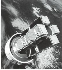
8 Galileo-Satelliten auf der Trägerrakete (© EADS) Ariane-5 montiert.
