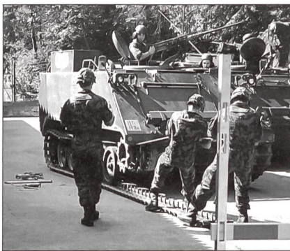
Panzermechaniker bei der Montage einer Raupe auf dem M 113 Schützenpanzer.
