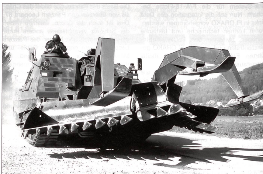
Der in der Schweiz entwickelte neue Minenräumpanzer räumt und sprengt Minen auf einer Breite von 4,2 Metern und leistet wertvolle Arbeit in Katastrophengebieten oder im Rahmen von friedenserhaltenden Aufgaben.
