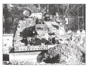
Der auf dem Chassis des Kampfpanzers Leopard neu entwickelte Geniepanzer im Truppentest in Holland.
