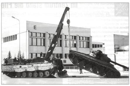
Aufgabe der Pzm/Wafm RS 52 Thun ist auch die Erprobung von neuem Gerät. Mühelos hebt der sich in Erprobung für unsere Armee befindliche neue Bergepanzer «Büffel» mit dem Kran den 40 Tonnen schweren Panzer an.
