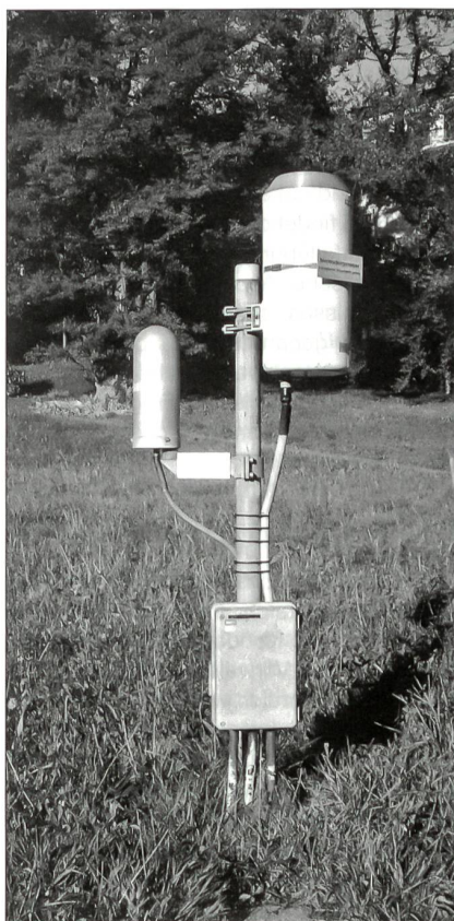
NADAM-Sonde, als Messgerät für die radioaktive Verstrahlung an verschiedenen Standorten montiert.
