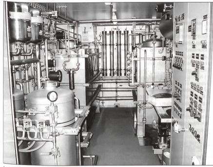
Innenleben der Wasseraufbereitungsanlage im Container.
