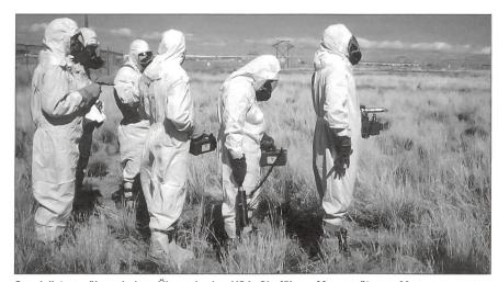
Spezialisten während einer Übung in den USA. Sie führen Messgeräte zur Messung von Alpha-, Beta- und Gamma-Strahlung mit sich.
