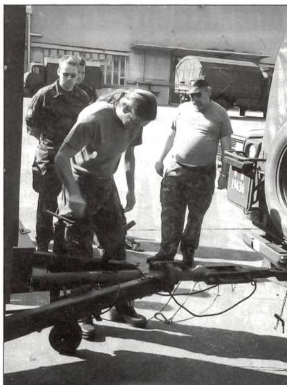
Korrektes Anhänger anhängen.
