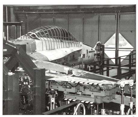
Das Flugzeug Nr. 35 wird mit etwa 80 Hydraulikzylindern durchgerüttelt mit dem Ziel, Ermüdungsbrüche frühzeitig zu erkennen.
