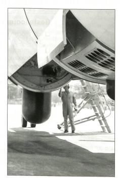
Der Flugingenieur beim Preflight-Check; das ausgefahrene Überwasserradar links neben ihm ist gut zu erkennen.
