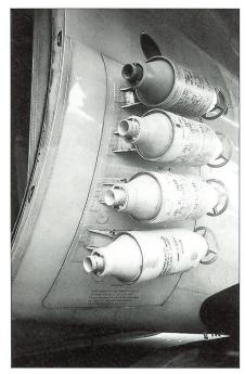
Auf Höhe der hinteren Seitentüren können je vier ATO-Startraketen montiert werden. Einmal gezündet, brennen sie während zehn bis elf Sekunden ab und erhöhen mit ihrem Schub die Geschwindigkeit um rund sieben bis acht zusätzliche Knoten.
