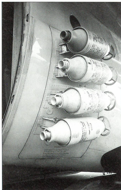
Auf Höhe der hinteren Seitentüren können je vier ATO-Startraketen montiert werden. Einmal gezündet, brennen sie während zehn bis elf Sekunden ab und erhöhen mit ihrem Schub die Geschwindigkeit um rund sieben bis acht zusätzliche Knoten.
