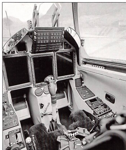
Der PC-21 besitzt ein vollständig digitales und integriertes Cockpit.
