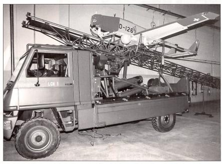
Die Ranger-Drohne wird ab einem speziellen fahrbaren Katapult gestartet, die Landung erfolgt auf Kufen.
