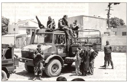
Auf dem 2-Tonnen-Mercedes-Unimog ist ein Maschinengewehr MG3 montiert.
