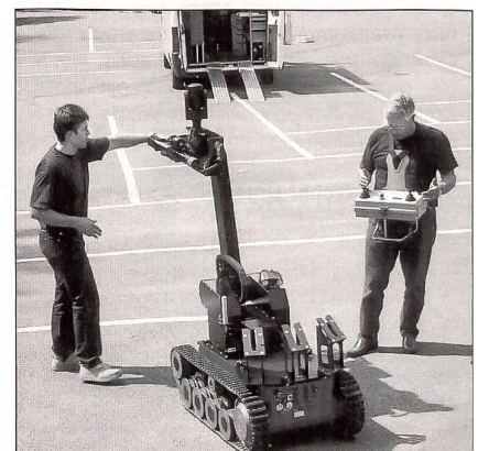
Roboter «Theodor» wird zum Einsatz vorbereitet. Der Beamte (links) lädt die Sprengvorrichtung, während der andere Beamte die tragbare Steuervorrichtung kontrolliert. Im Hintergrund das Einsatzfahrzeug.
