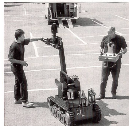
Roboter «Theodor» wird zum Einsatz vorbereitet. Der Beamte (links) lädt die Sprengvorrichtung, während der andere Beamte die tragbare Steuervorrichtung kontrolliert. Im Hintergrund das Einsatzfahrzeug.
