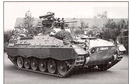
Schützenpanzer «Marder 1» mit 2-cm-Maschinenkanone und MILAN-PAL.
