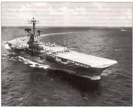
Diese Aufnahme zeigt die «USS Hornet» (CVS-12) in der U-Boot-Abwehrträger-Konfiguration im Jahre 1967, drei Jahre vor der endgültigen Ausserdienststellung. Hier verfügt der Träger vor allem über S-2F-«Tracker»-U-Boot-Abwehrflugzeuge sowie über SH-3-U-Boot-Abwehrhelikopter des Typs «Seaking».
