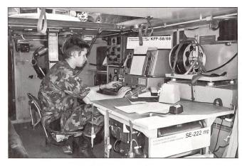
Kurzwellenfunkstation SE 222/mp im Schützenpanzer M119 eingebaut.
