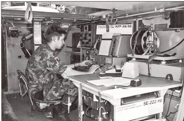
Kurzwellenfunkstation SE 222/mp im Schützenpanzer M119 eingebaut.
