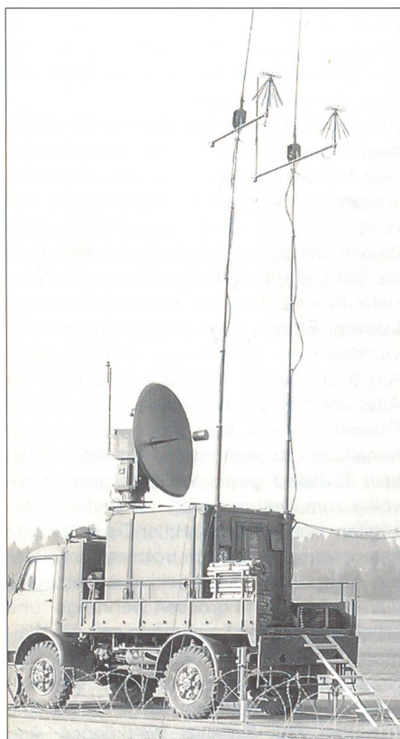
Mobile Bodenstation, aufgebaut auf einem Saurer 10DM.
