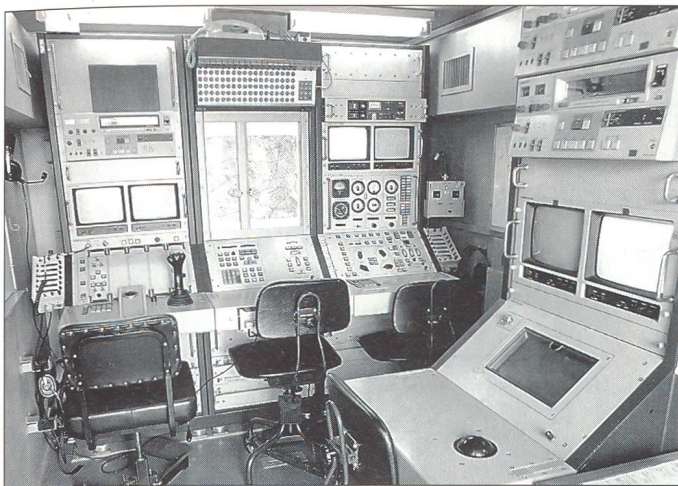
Die Einsatzkontrollstation ADS 95 mit den Arbeitsplätzen (v. l.) für Nutzlastbediener, Navigator, Pilot und Benützervertreter ist in einem Container auf einem Saurer 10DM untergebracht. (Bilder GR/SF/FUaid).
