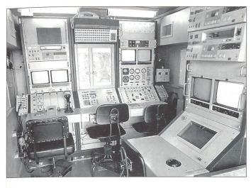
Die Einsatzkontrollstation ADS 95 mit den Arbeitsplätzen (v. l.) für Nutzlastbediener, Navigator, Pilot und Benützervertreter ist in einem Container auf einem Saurer 10DM untergebracht. (Bilder GR/SF/FUsid).
