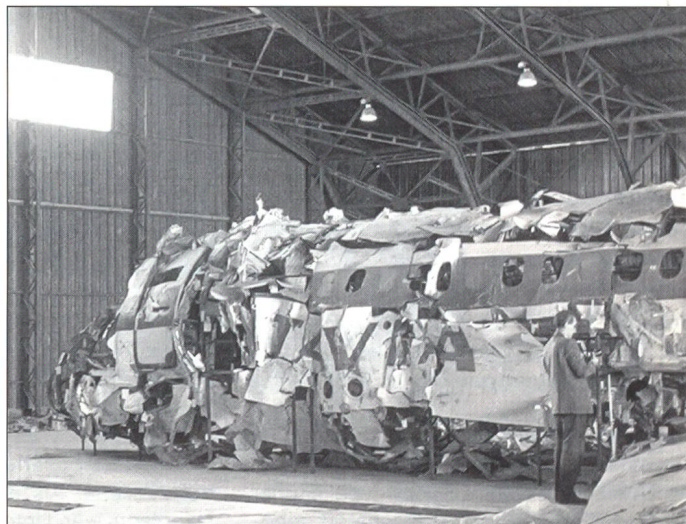
Zusammengesetzter Rumpf der DC-9-15. Über 5000 Wrackteile wurden vom Grund des Mittelmeeres geborgen.
