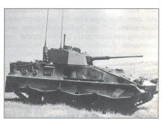
Der Schützenpanzer «Ulan» mit einer 3-cm-Maschinenkanone.
