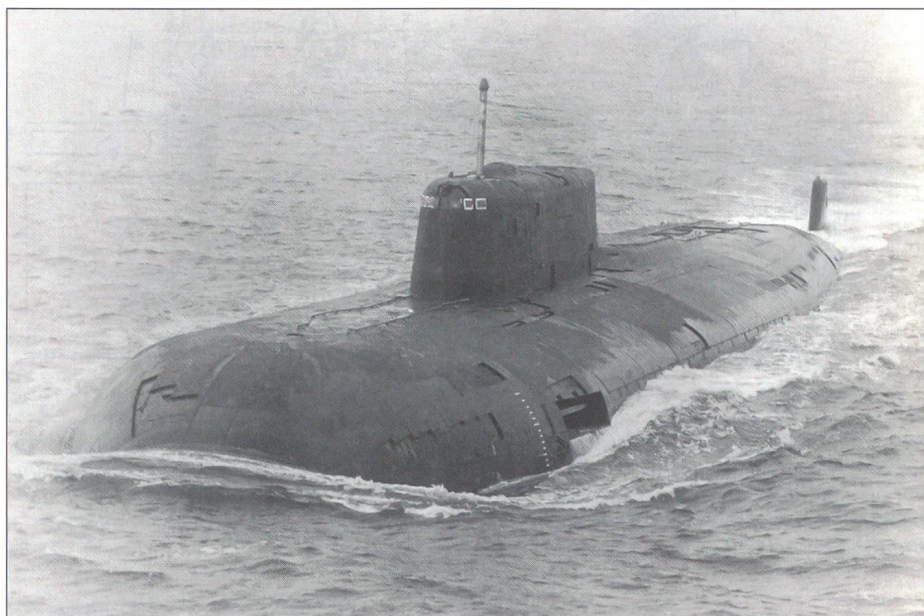
Eine Luftaufnahme der «Kursk», aufgenommen von einem P-3B-Longstreckenaufklärer «Orion» der Königlich-Norwegischen Luftwaffe. Die gewaltigen Ausmasse des Bootes sind auf den doppelten Rumpf (eine äussere und innere, die so genannte Druckhülle) zurückzuführen, die die Boote weniger verwundbar machen.
