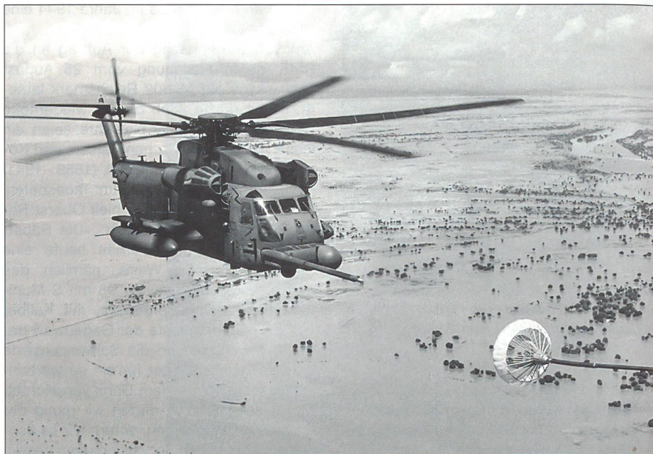
Um einen Pave Low in der Luft betanken zu können, muss die Betankungs-sonde ausgefahren werden.
