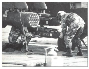
Ein Pilot und ein Soldat der Bodencrew montieren eine AGM114 Hellfire am inneren Waffenträger eines Apache. Die Lenkwaffe hat eine Reichweite von mehr als 8 Kilometern.
