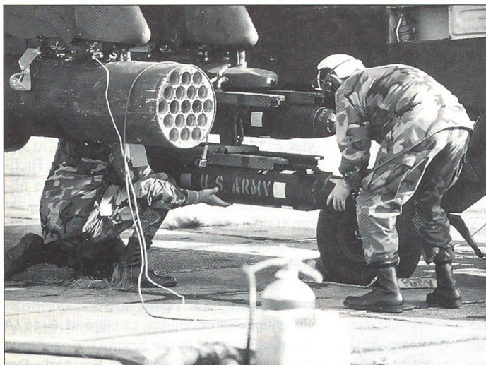
Ein Pilot und ein Soldat der Bodencrew montieren eine AGM-114 Hellfire am inneren Waffenträger eines Apache. Die Lenkwaffe hat eine Reichweite von mehr als 8 Kilometern.
