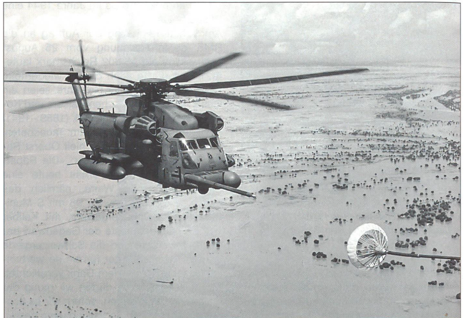
Um einen Pave Low in der Luft betanken zu können, muss die Betankungssonde ausgefahren werden.
