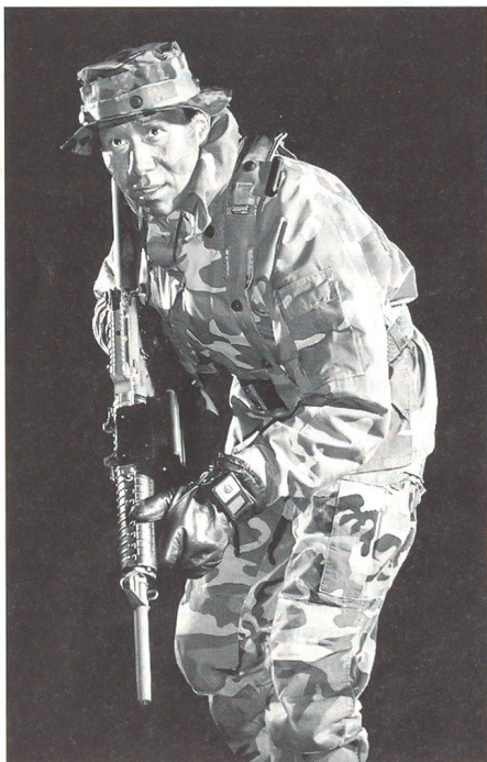
Soldat im Einsatz mit Simlas 01. Erkennbar sind die Systemkomponenten «Laser», montiert auf Gewehr, «Input-Output-Vorrichtung» am Handgelenk und die «Sensoren» auf Kopfeinheit und Grundtrageinheit.
