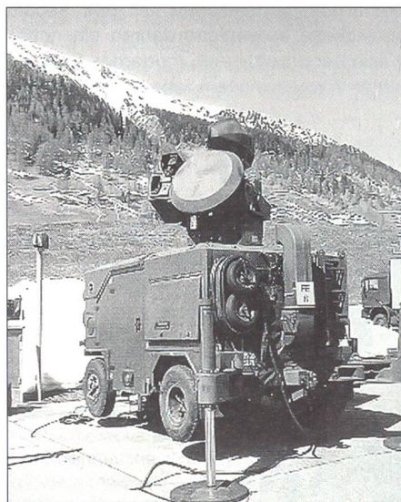
Das kampfwertgesteigerte Feuerleitgerät Skyguard 75/90
