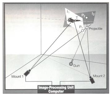
So funktioniert das Versetztzielschiessen: Das Flugziel und die Schussgarbe werden elektro-optisch verfolgt und die dreidimensionale Flugbahn des Flugzieles und der Geschosse via Trianulation berechnet.
