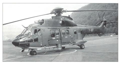
Der Super Puma T-317 diente als Versuchsträger für das FLIR/TV-System. Vor der linken Kabinentüre ist die Aufhängung mit der Kamerakugel zu sehen.
