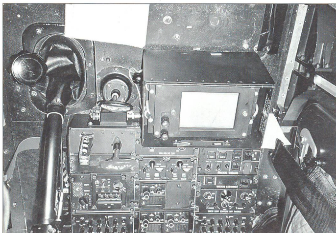
Auch im Cockpit befindet sich hinter der Mittelkonsole ein Monitor für die Piloten.
