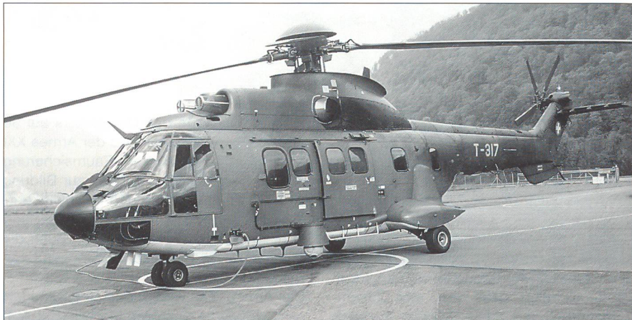
Der Super Puma T-317 diente als Versuchsträger für das FLIR/TV-System. Vor der linken Kabinentüre ist die Aufhängung mit der Kamerakugel zu sehen.
