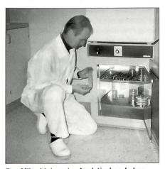
Der Mikrobiologe im Analytischen Labor überprüft die Nährmedien im Brutschrank, ob bereits sichtbare Anzeichen einer Verkeimung der Produkte, Umgebungsluft oder der Arbeitsflächen vorhanden sind in Form von z.B. Hefe- oder Schimmelpilzen.
